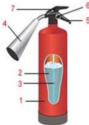
Рис. 8. Конструкция переносного углекислотного огнетушителя.
