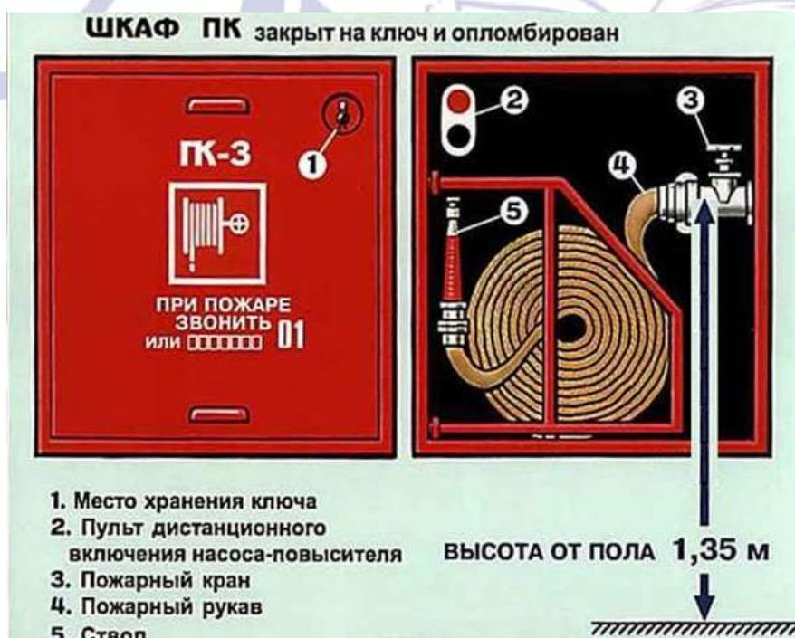
Рис. 13. Требования к размещению внутреннего пожарного крана.
